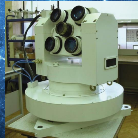
Опытный образец широкопольной телевизионной регистрирующей станции
