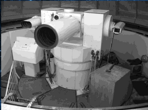
Модернизированный высокоточный кинотеодолит «Висмутин» на космодроме «Байконур»
