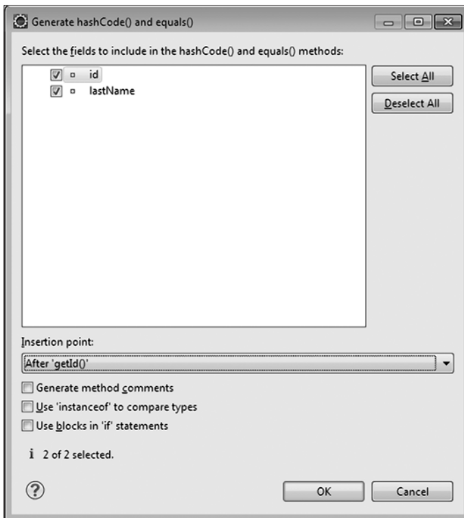
Рис. 16. Генерация equal & hashCode
