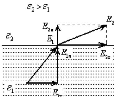
Рис.20. Преломление силовых линий на границе между диэлектриками
