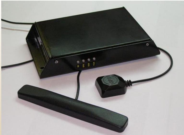
Определяют с помощью спутниковой навигационной системы GPS местоположение транспортного средства, считывают сигналы от автомобильных датчиков и отсылают измерительную информацию в центр мониторинга с помощью системы мобильной GPRS-связи
