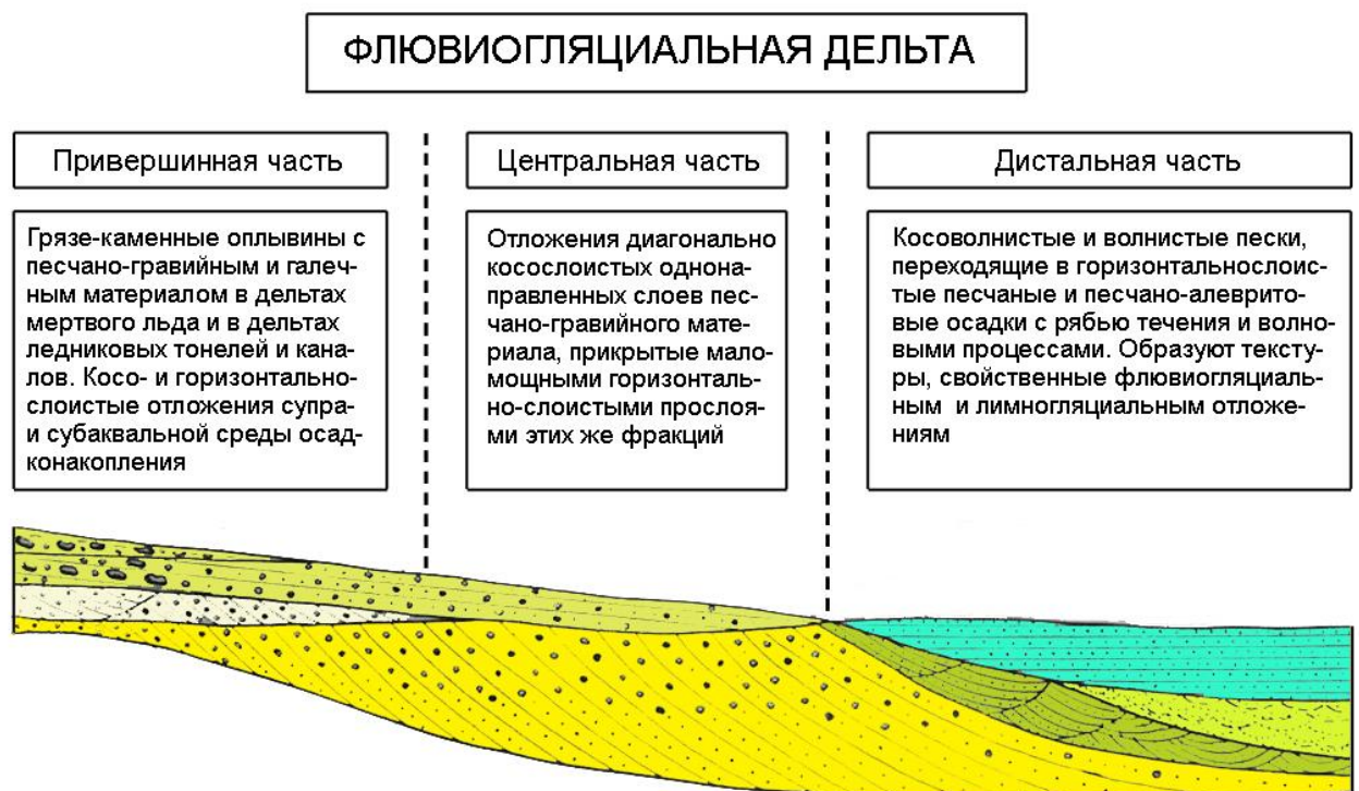
Рис. 4.11. Схема строения и динамики осадконакопления флювиогляциальной дельты (по А.П. Микалаускасу)
