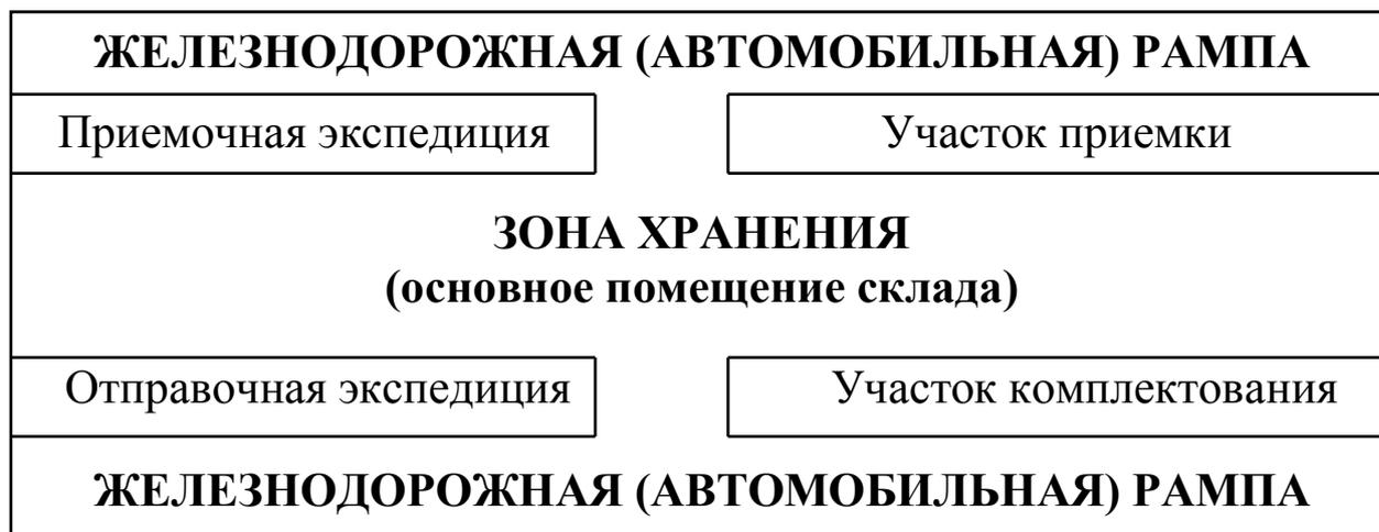
*Рисунок 8.1 – Принципиальная схема склада*
