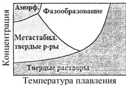
Рис. 3.20. Схема фазовых состояний в металлических материалах, подвергнутых ионно-лучевой обработке при высокой плотности ионного тока
