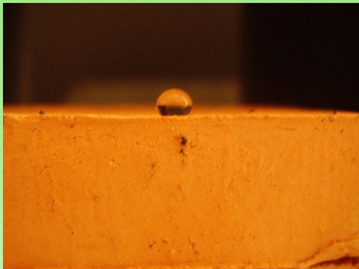
Кирпич, обработанный гидрофобизатором
